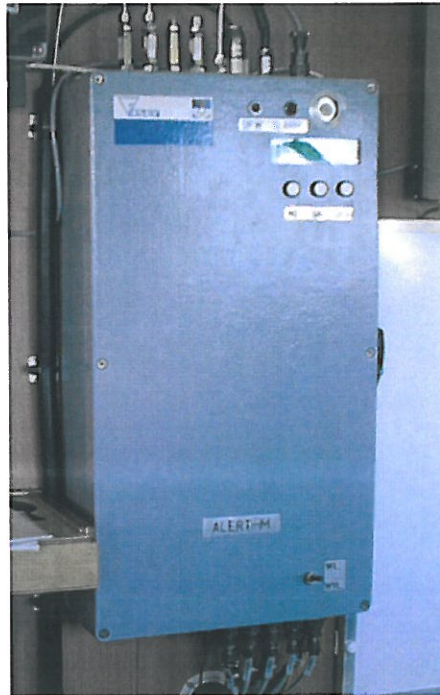
Rys. 5. Sygnalizator skażeń chemicznych ALERT-1M [H1].
