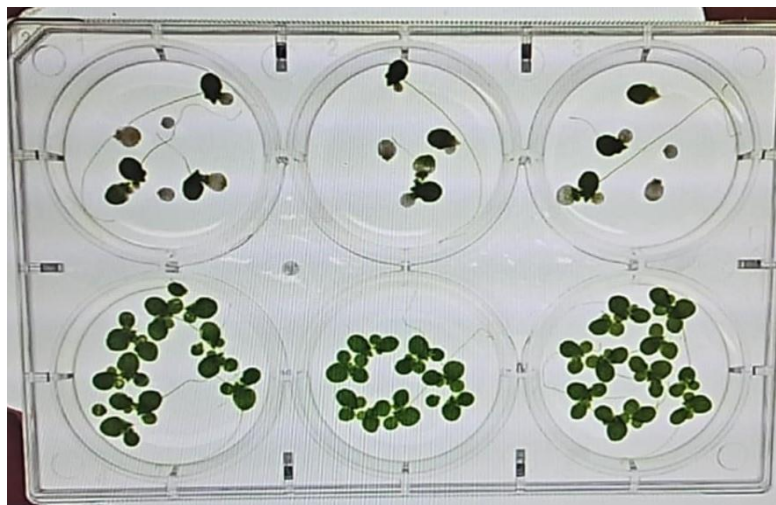
Rysunek 1. Zdjęcie płytki testowej Lemna minor , przedstawiające zahamowanie wzrostu rośliny w obecności kolejno malejących stężeń sulfametoksazolu, począwszy od górnego lewego dolka
