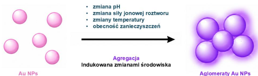
Rysunek 5. Schemat procesu aglomeracji Au NPs indukowanej zmianami warunków środowiskowych.
