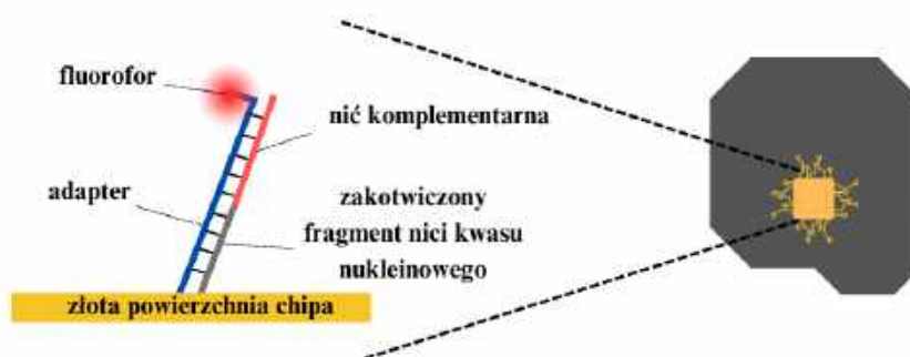
Rysunek 8. Schemat przedstawiający budowę powierzchni chipa po procesie funkcjonalizacji.
