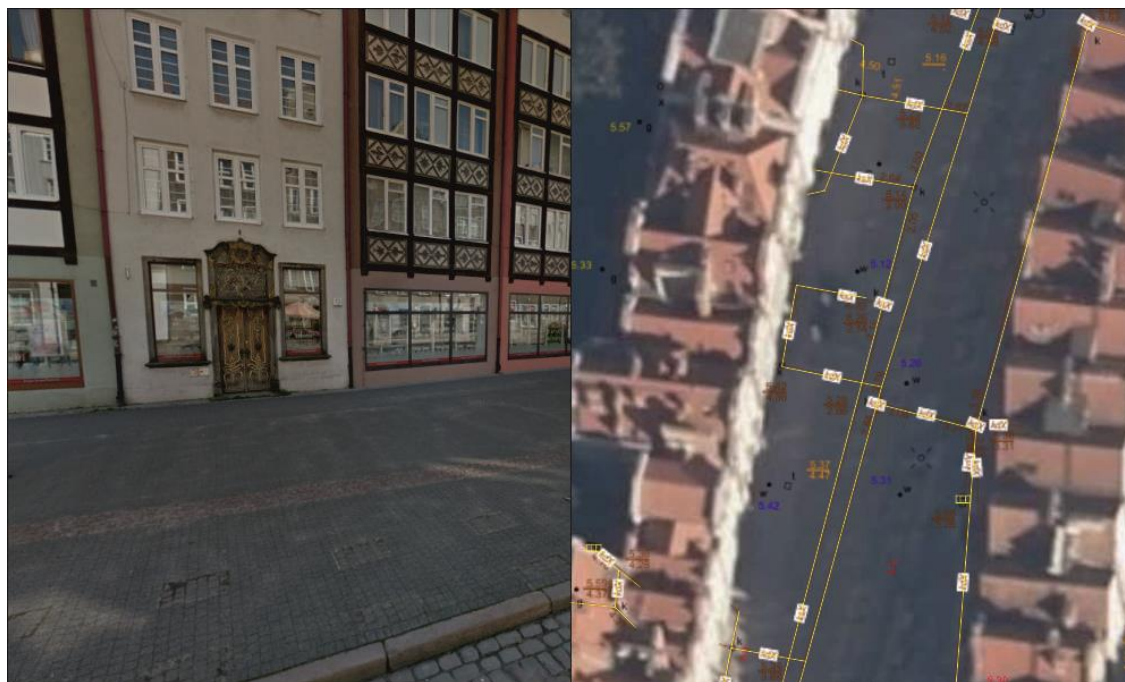
Ryc. 5.2.6. Wizualizacja scenariusza "1" wraz z lokalizacją studzienek oraz przyłączy na podstawie danych dyrektywy INSPIRE
